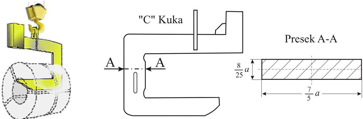
"C" - Kuka mosnog krana podiže čelične limove u koturovima pojedinačne mase od ***m=5,6 tona*** (vidi sliku). Dimenzionirajući pravougaoni poprečni presek ***a=? mm***, "C"-kuke na mestu **A-A** ako je ona izrađena od čelika zatezne čvrstoće  $\sigma_{zdoz} = 5 \cdot 10^7 Pa$  sa stepenom sigurnosti za kuku  $\gamma = 5$ .
