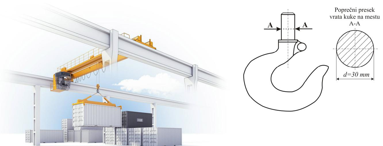
Jednakokraka kuka mosnog krana (vidi sliku), kružnog poprečnog preseka **d=30 mm** na mestu **A-A "vrat kuke"**, podiže kontener. Kuka je izrađena od čelika zatezne čvrstoće  $\sigma_{zdoz} = 4 \cdot 10^8 Pa$ . Ako je stepen sigurnosti za
