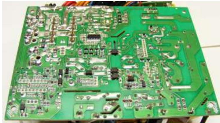
Slika 9: Prikaz donje strane elektronske ploče napajanja (bitan je kvalitet lemova)
