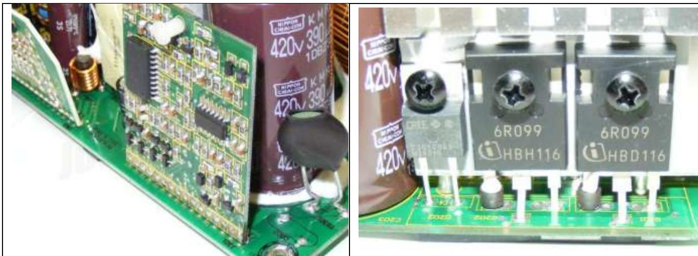
Slika 7: Kontrolna ploča sa PWM i PFC čipovima (levo) i tranzistori PFC kontrolnog kola (desno)
