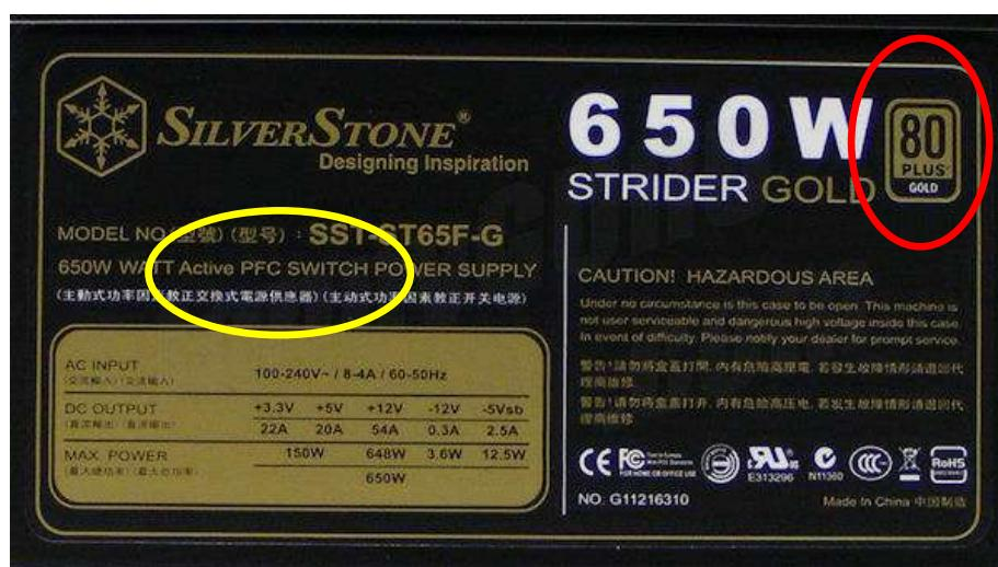
Slika 13: Oznaka aktivnog PFC faktora (levo) i 80PLUS Gold sertifikata (desno) na kućištu napajanja
