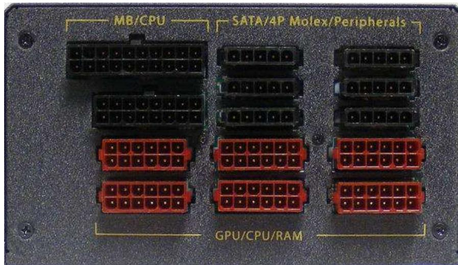
Slika 14: Prikaz modularnih konektora na kućištu napajanja
